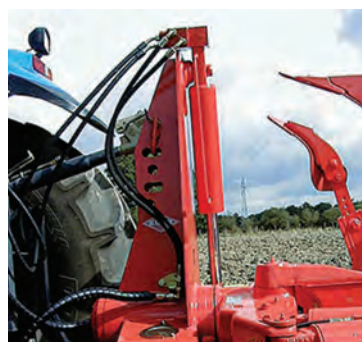
Рис. 24.15. Установлення горизонтального положення навісного плуга
