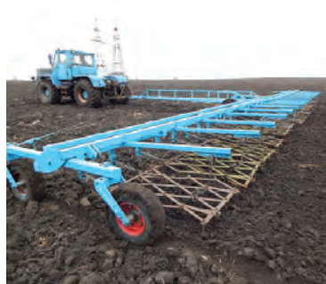
Рис. 24.26. Агрегат для боронування з колісним трактором
