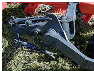
Рис. 24.14. Установлення глибини оранки
