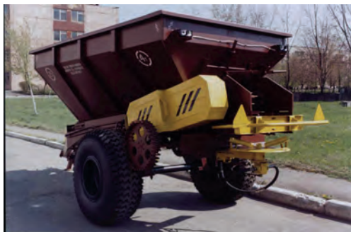
Рис. 20.1. Машина МРД-4 для розсіювання мінеральних добрив
