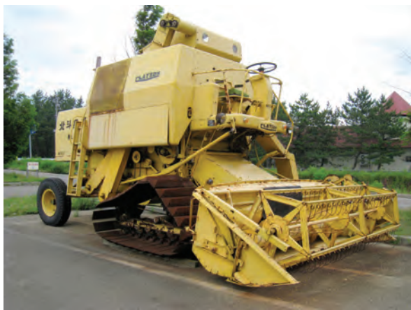
Рис. 34.1. Комбайн Claas на напівгусеничному ході для збирання рису
