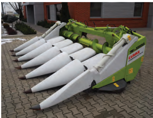
Рис. 31.1. Пристрій до зернозбирального комбайна для збирання кукурудзи
