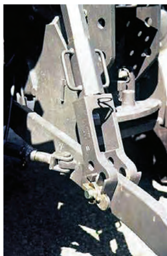
Рис. 24.4. Установлення нижніх поздовжніх тяг
