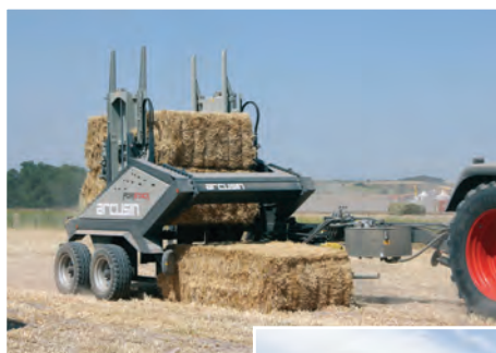
Рис. 28.5. Причіп для навантаження, транспортування і розвантаження тюків ForStack
