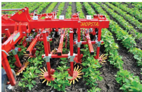
Рис. 7.2. Розпушування ґрунту в міжряддях
