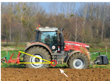
Рис. 24.10. Розміщення нижніх поздовжніх тяг і центральної тяги в робочому положенні на тракторах, які мають тільки задні приводні колеса
