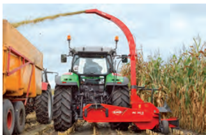
Рис. 21.7. Навісний подрібнювач кукурудзи на силос MC 90S Twin
