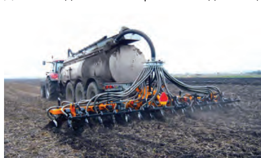
Рис. 27.4. Агрегат для ґрунтового внесення рідких органічних добрив SN800
