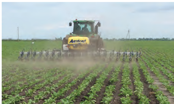
Рис. 26.1. Культиватор для міжрядного обробітку Gelio-K
