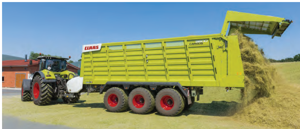
Рис. 36.5. Транспортування силосу до місця закладання причепом Claas Cargos 9600
