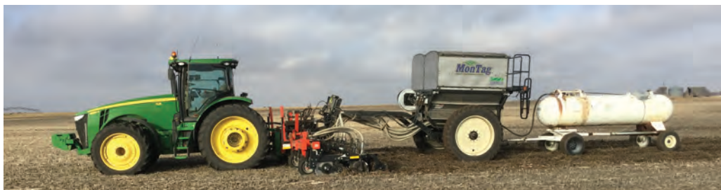
Рис. 27.5. Машини Mon Tag для внесення рідких добрив у ґрунт під час його обробітку
