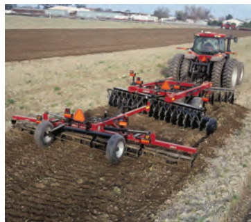
Рис. 24.25. Комбінований агрегат для лушення стерні з одночасною підготовкою до сівби
