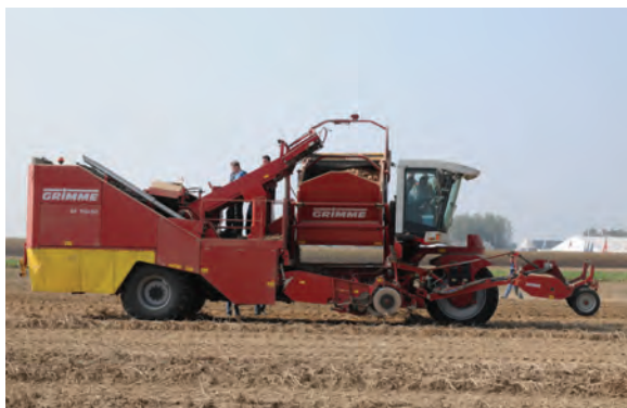
Рис. 39.3. Самохідний картоплезбиральний комбайн Grimme SF 150-60
