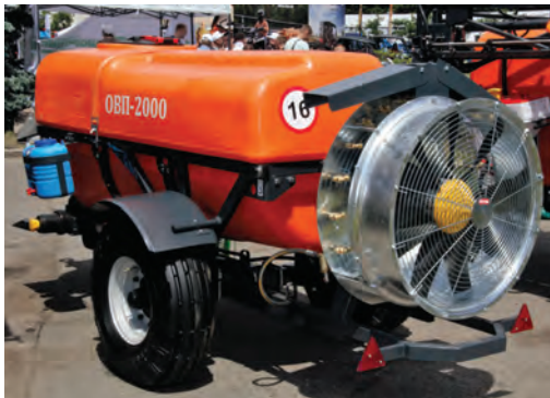
Рис. 18.6. Вентиляторний обприскувач ОВП-2000
