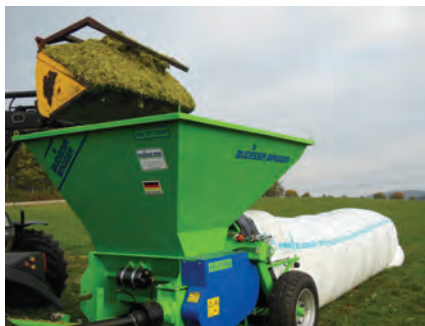
Рис. 36.8. Завантаження силосу в поліетиленовий рукав
