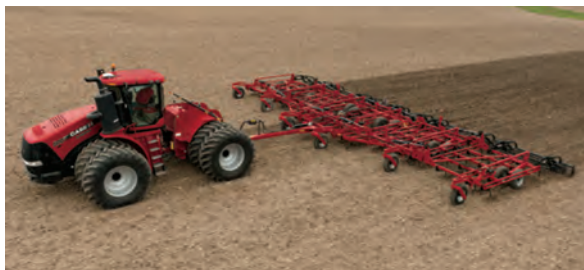
Рис. 24.29. Комплекс для передпосівної підготовки ґрунту Case IH Tiger-Mate 255
