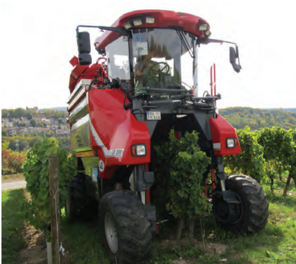
Рис. 42.1. Виноградозбиральний комбайн ERO Grapeliner SF200
