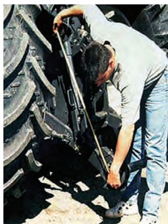
Рис. 24.5. Вимірювання відстані від верхньої точки вертикальної підйомної тяги до точки навішування знаряддя
