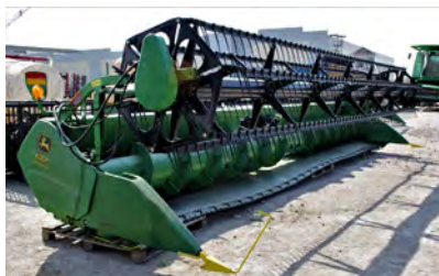
Рис. 33.2. Жатка John Deere 630F HydraFlex для збирання сої
