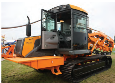
Рис. 29.2. Екскаватор для прокладання закритого дренажу ЕТЦ-203
