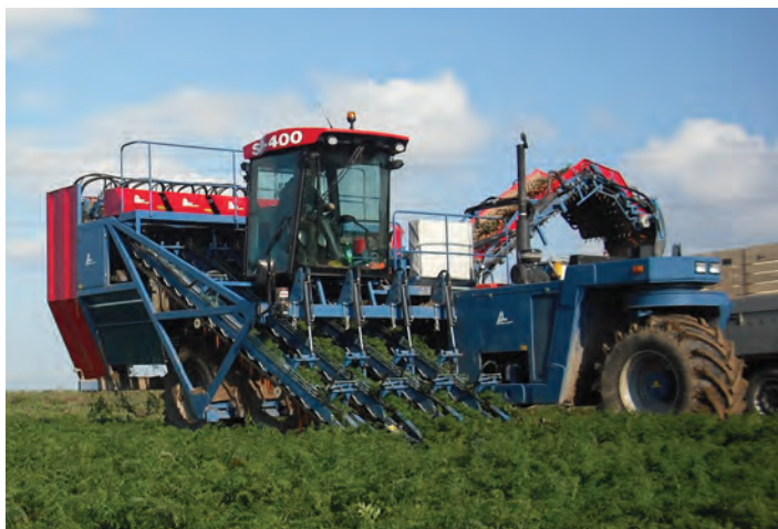
Рис. 40.2. Робота комбайна ASA-LIFT SP-200CF на збиранні моркви з одночасним навантаженням у транспортні засоби
