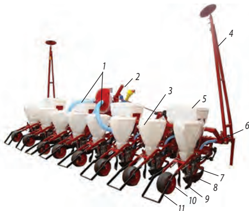
Рис. 17.4. Універсальна пневматична сівалка СУПН-8А
