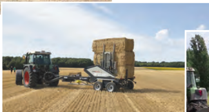
Рис. 28.6. Навантаження, транспортування і розвантаження тюків причепом ForStack (зліва направо)
