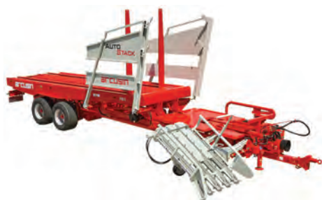
Рис. 28.1. Причіп для перевезення тюків AutoStack FSX
