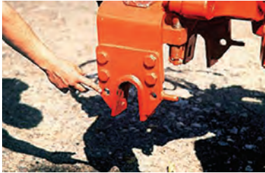
Рис. 24.8. Два положення нижніх точок навіски
