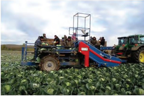
Рис. 19.6. Причипний капустозбиральний комбайн ТК-1000
