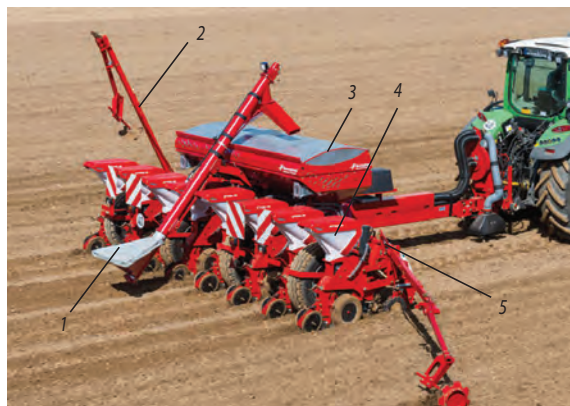
Рис. 17.6. Загальний вигляд сівалки Optima 1 – завантажувач мінеральних добрив; 2 – маркер; 3 – бункер мінеральних добрив; 4 – висівна секція; 5 – рама
