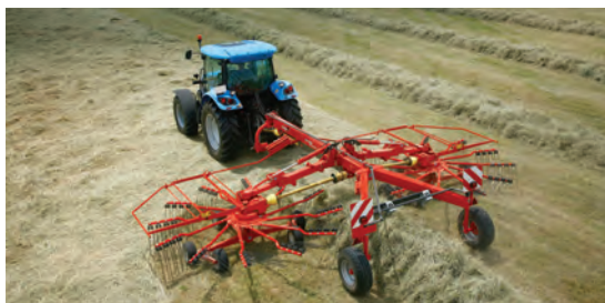
Рис. 21.5. Валкоукладач роторний GA 7501
