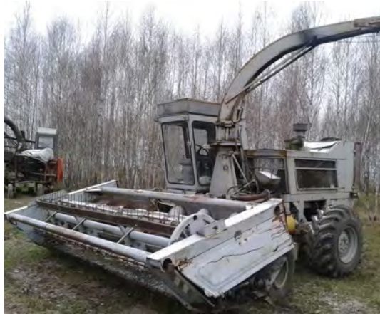
Рис. 36.1. Силосозбиральний комбайн КСК-100
