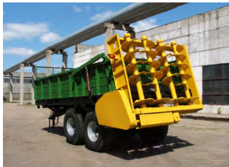
Рис. 27.1. Розкидач твердих добрив РТД-9
