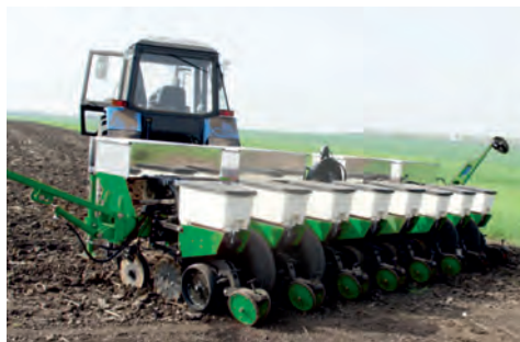
Рис. 25.1. Зернова сівалка точного висіву СПМ-8 «Ніка-8»
