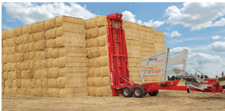
Рис. 28.4. Розвантаження тюків причепом AutoStack FSX
