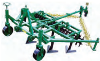
Рис. 24.19. Агрегат комбінований швидкісний АКШ-2,5
