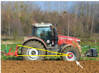
Рис. 24.9. Розміщення нижніх поздовжніх тяг і центральної тяги у робочому положенні на тракторах із повним приводом
