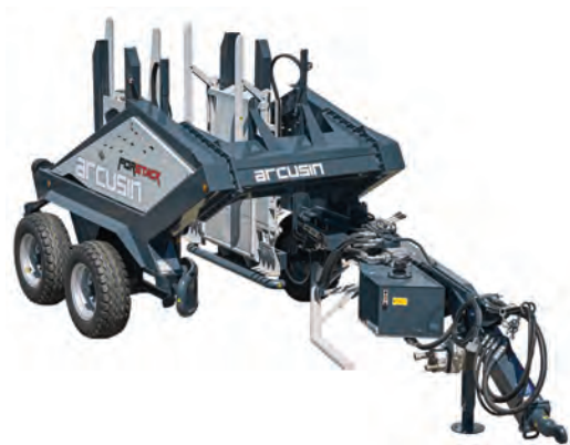
Рис. 28.5. Причіп для навантаження, транспортування і розвантаження тюків ForStack
