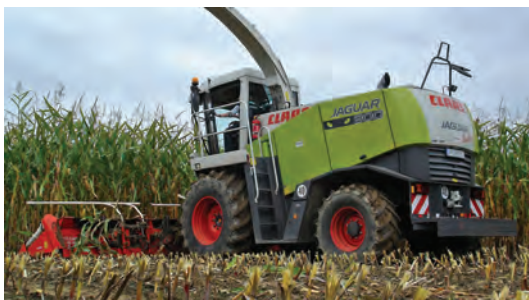
Рис. 36.4. Самохідний кормозбиральний комбайн Claas Jaguar 900
