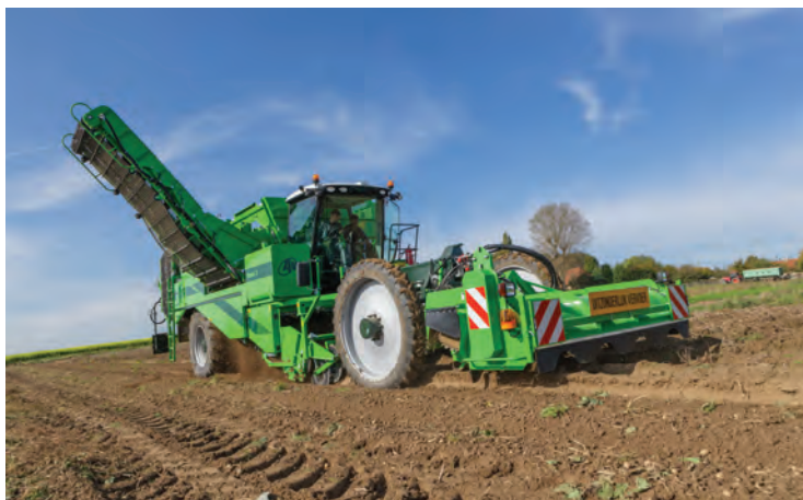
Рис. 39.1. Самохідний картоплезбиральний комбайн «Пума»
