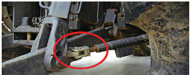
Рис. 24.11. Положення стабілізаторів під час транспортування
