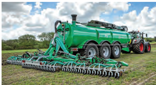
Рис. 27.6. Агрегат PG для прикореневого внесення рідких мінеральних добрив
