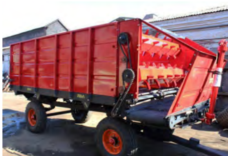
Рис. 21.10. Кормороздавач тракторний універсальний КТУ-10А
