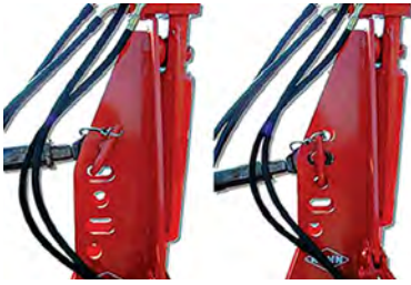
Рис. 24.7. Отвори для кріплення центральної тяги
