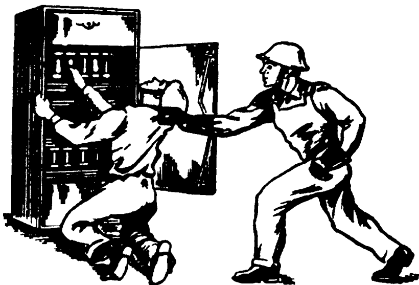
Рис. 22. Відокремлення потерпілого від струмопровідної частини, що знаходиться під напругою до 1000 В
