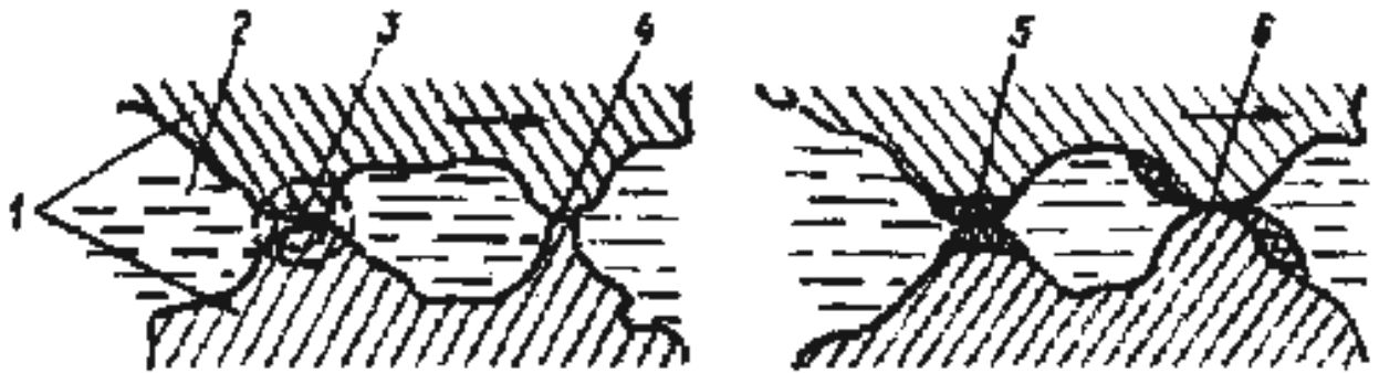
Рис. 5. Особливості тертя: масло без присадки (а) та з хімічно активною присадкою (б); 1 – тертьові поверхні; 2 - масло; 3 - "крапка контакту"; 4 - момент зварювання поверхні деталей; 5 - утворення хімічної плівки; 6 - полірування деталей.
