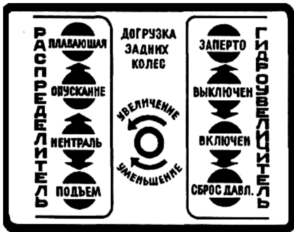
Рис.5.2. Схема керування гідравлічною системою трактора МТЗ - 80
