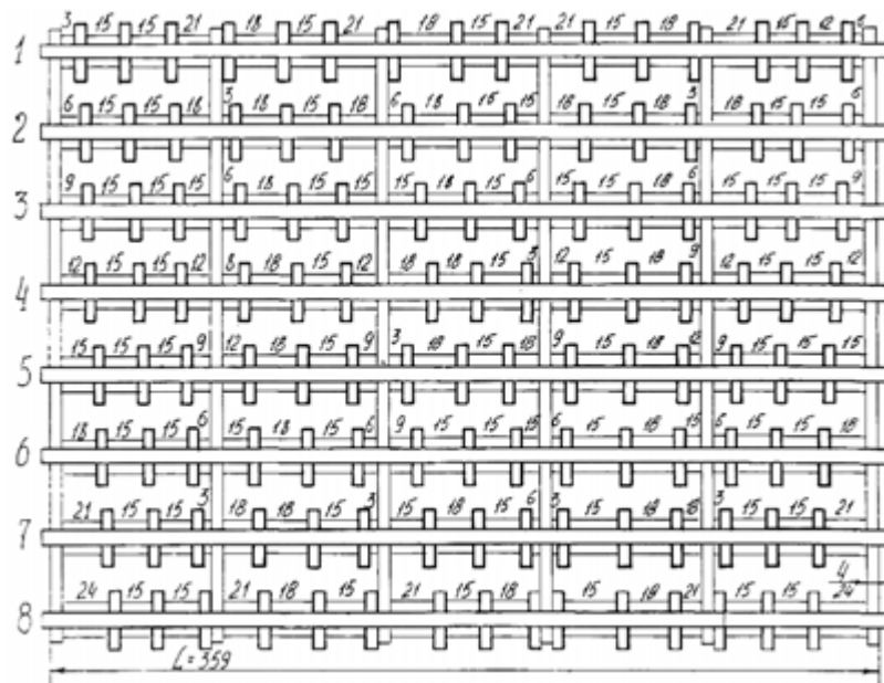
Рис. 3.58. Схема розміщення молотків дробарки (цифрами позначена довжина розпірних втулок, а зліва - номери осей підвісу молотків)
