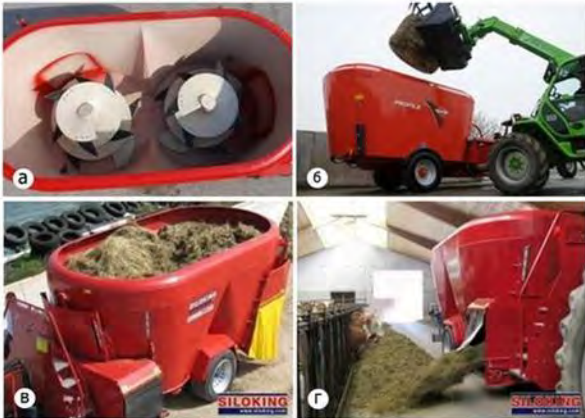
Рис. 6.5. Робочий процес кормороздавача Siloking: а – вигляд бункеру для змішування кормів зверху; б – завантаження компонентів (тюкована маса); в – подрібнення і змішування кормів; г – роздавання кормів тваринам
