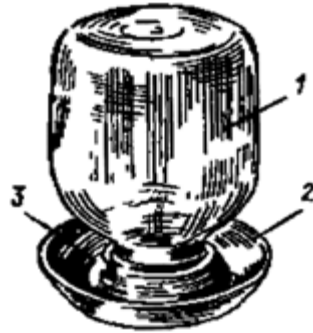
Рис. 9.21. Вакуумна напувалки для птиці:
