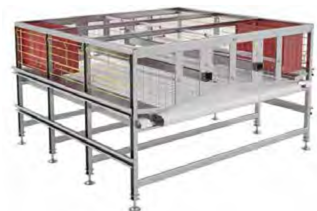
Рис. 7.18. Модель кліткової батареї для утримання курей-несучок
