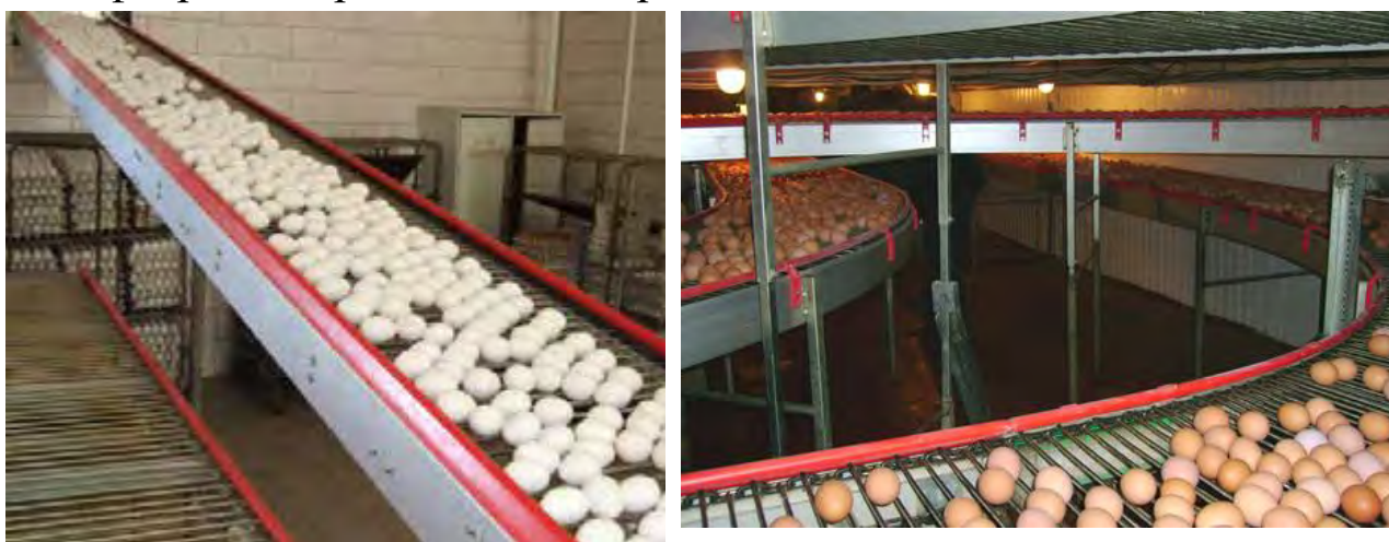
Рис. 16.6. Пруткові транспортери для яєць.
