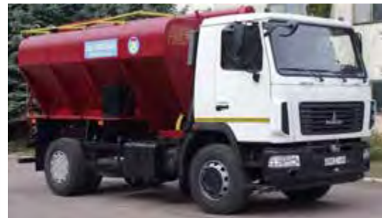
Рис. 11.31. Технологічна схема і вигляд завантажувача сухих кормів: 1 – автомобіль; 2 – напрямний лотік; 3 – вивантажувальний шнек; 4 – секційний бункер; 5 – шиберна заслінка; 6, 13 – підшипники; 7 – піднімальний пристрій; 8 – перехідник; 9 – вертикальний шнек; 10 – поворотний пристрій; 11 – редуктор; 12 – горизонтальний шнек; 14, 15 – ланцюгова і карданна передачі
