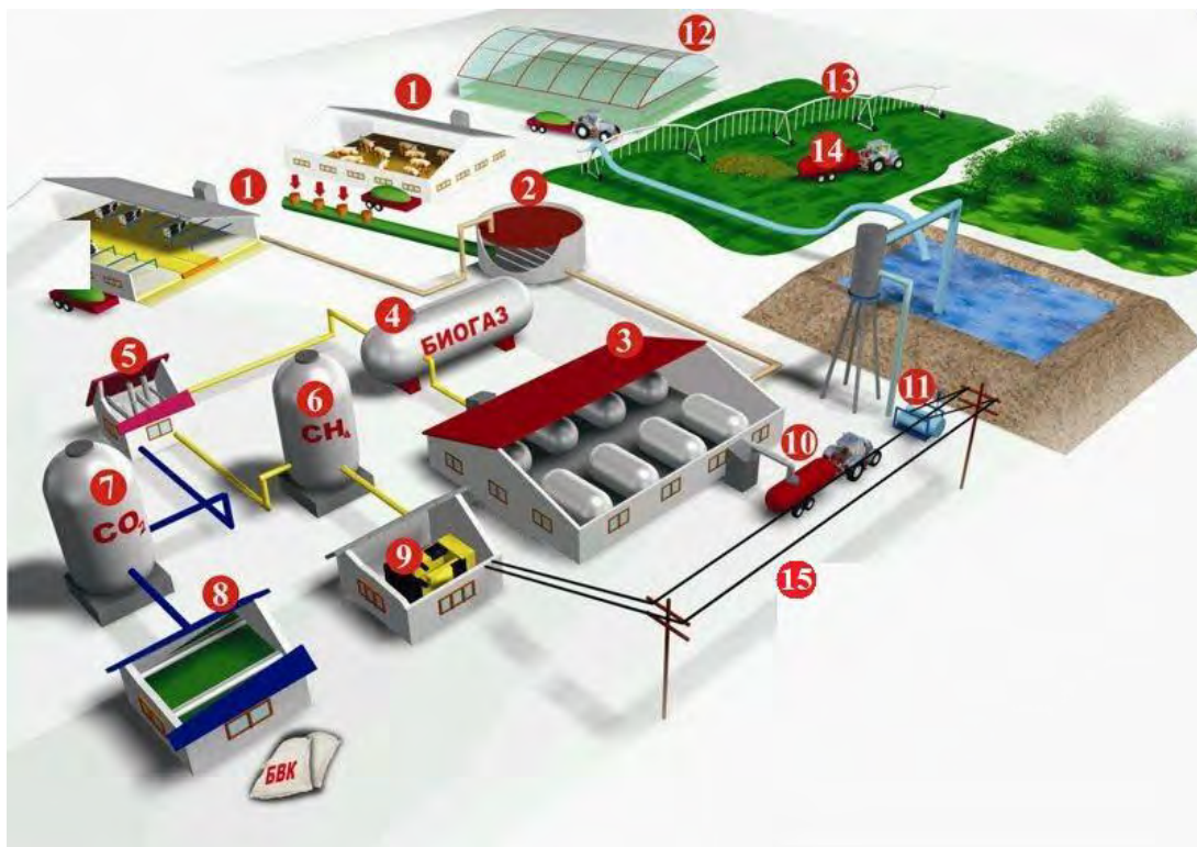
Рис. 11.3 Структурна схема переробки і використання рідкого гною: 1 – тваринницьке підприємство; 2 – ємкість для прийому екскрементів; 3 – біогазова установка; 4 – газгольдер для збору біогазу; 5 – вуглекислотна роздільна колонка; 6 – газгольдер з метаном; 7 – газгольдер вуглекислою; 8 – отримання біологічного вітамінного концентрату; 9 – газогенератор; 10 – вивіз отриманих мінеральних азотних добрив; 11 – електронасос; 12 – пункт знезараження гною у випадках епізоотії; 13 – теплиця вирощування гідропоніки; 14 - внесення мінеральних азотних добрив; 15 – лінія електропередач.
