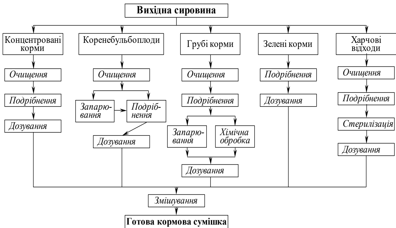
Рис. 1.3. Найпоширеніші технологічні схеми підготовки до згодовування кормових компонентів і приготування сумішок
