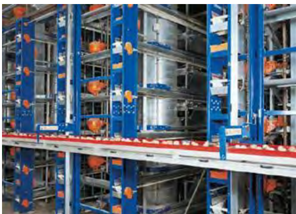
Рис. 16.3. Системи збирання яєць з кліткових батарей: а - ліфтова система; б - елеваторна система
