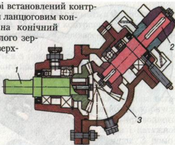
Рис. 5.39. Редуктор похилого шнека: 1 — ведучий вал; 2 — ведений вал; 3 — кожух
