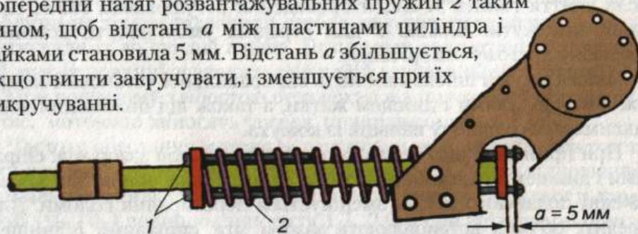
Рис. 8.16. Регулювання розвантажувальних пружин 2 механізмом гвинтів 1 до зазору a = 5 мм
