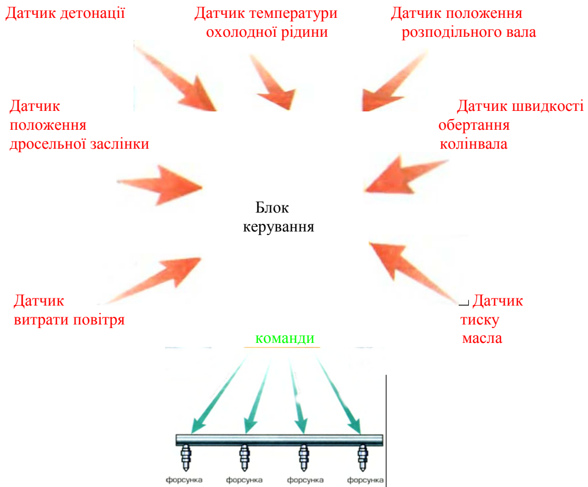
Мал. 20. Принцип роботи бортового комп'ютера.
