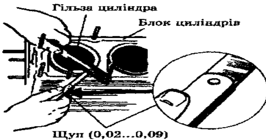
Рис. 7. Установлення гільз у блоці циліндрів двигуна ЗМЗ-53 (ЗМЗ-511.10)
