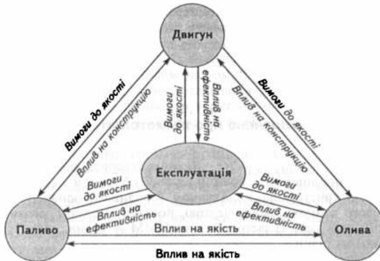
Рис. 1.4. Хімотологічна чотириланкова система: двигун—паливо—олива—експлуатація
