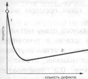
Рис. 1.12. Міцність кристалу залежно від кількості дефектів
