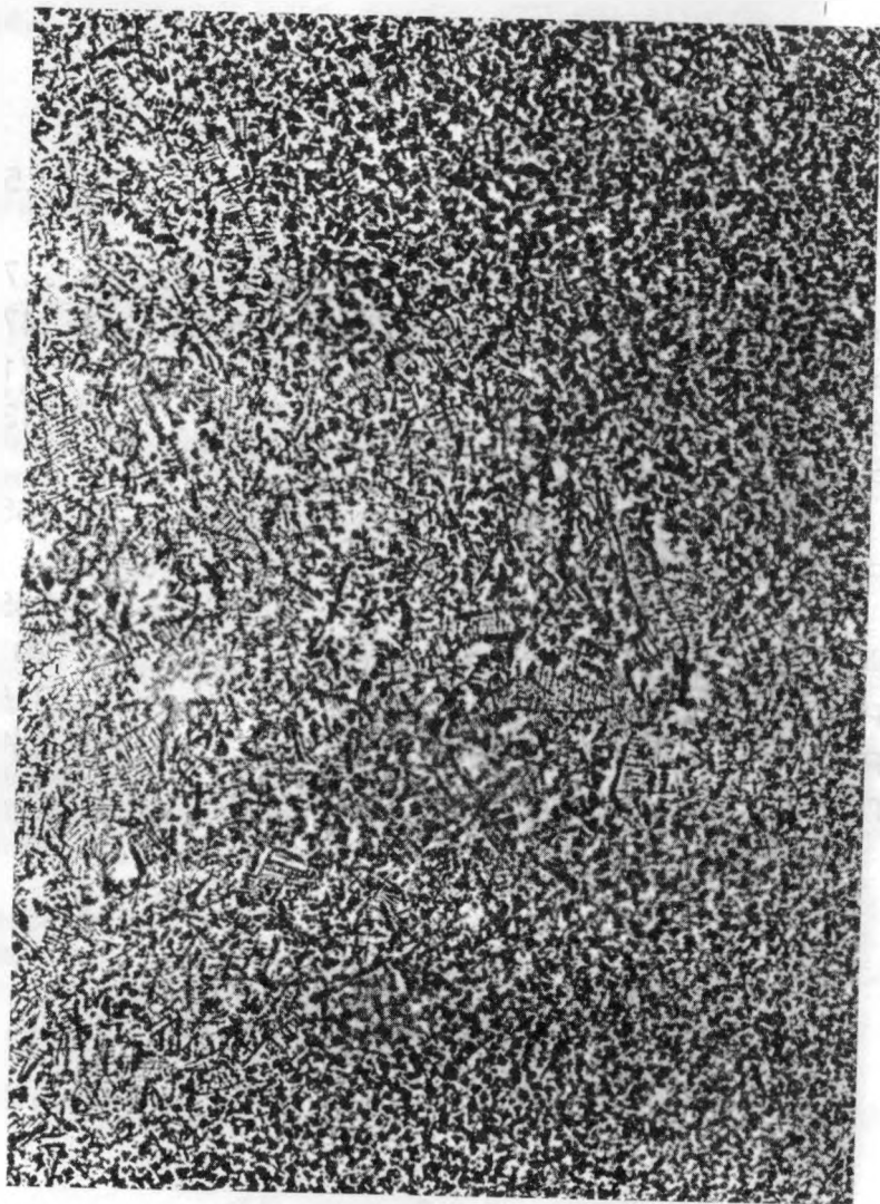
Зона рівноосних дендритів у виливку (3,5 т) середньовуглецевої сталі
