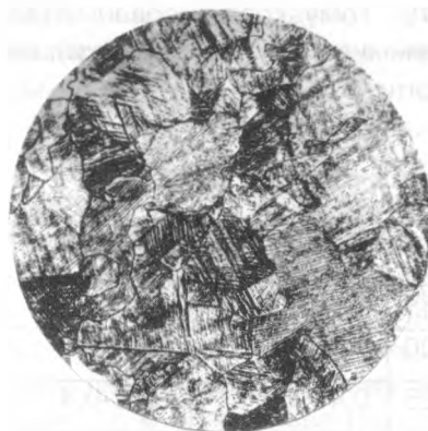
Рис. 5.10. Мікроструктура сталі 110Г13Л після наклепування, \times 200
