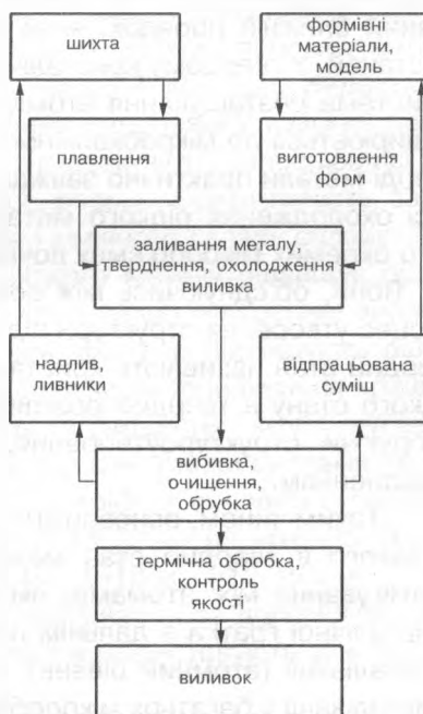
Рис. 6.11. Схема технологічного процесу виготовлення виливка
