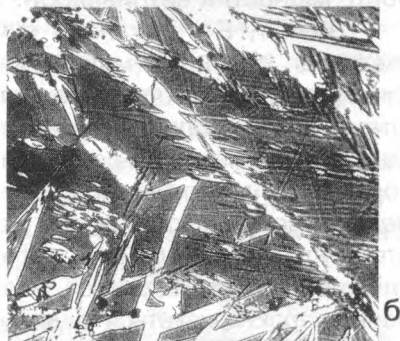
Рис. 3.7. Структури мартенситу: а - х350; б - х500
