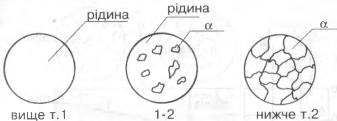
Рис. 2. 4,в. Схема утворення структурних складових сплаву К при повільному охолодженні
