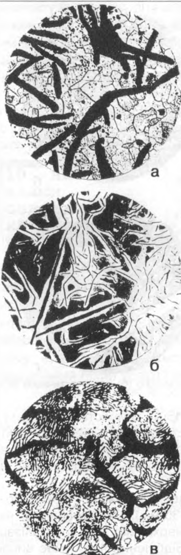
Рис. 3.10. Структури сірого чавуну з феритною (а); феритно-перлітною (б); перлітною (в) основами, \times 200
