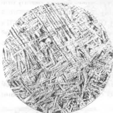
Рис. 5.21. Мікроструктура сплаву BT6 після деформації і відпалу, \times 250
