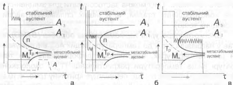
Рис. 4.10. Температурно-часова схема режимів термомеханічної обробки: а - ВТМО, б - НТМО, в - ізоформінг
