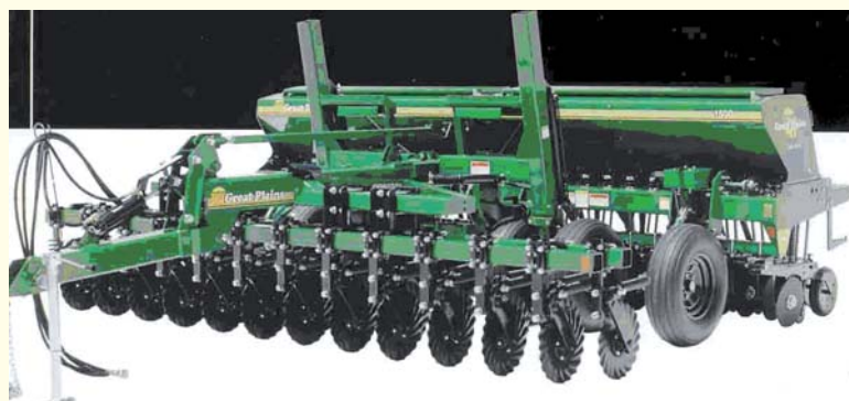
Рис. 2.20 – Загальний вигляд сівалки PH 2000F для безпосередньої сівби фірми Great Pleains з модулем хвилястих різальних дисків
