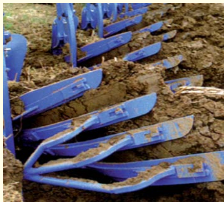
Рис. 1.10 – Вигляд плужного корпусу "Dora Maxx" фірми Lemken з клеєними пластинчастими полицями в роботі
