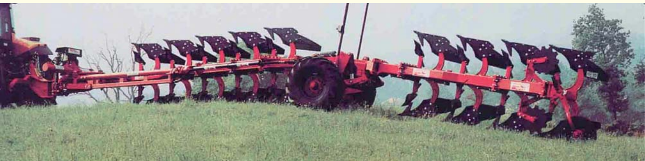
Рис. 1.1 – Загальний вигляд плуга SPF9 фірми Gregoire Besson з шарнірно-з'єднаною рамою.
