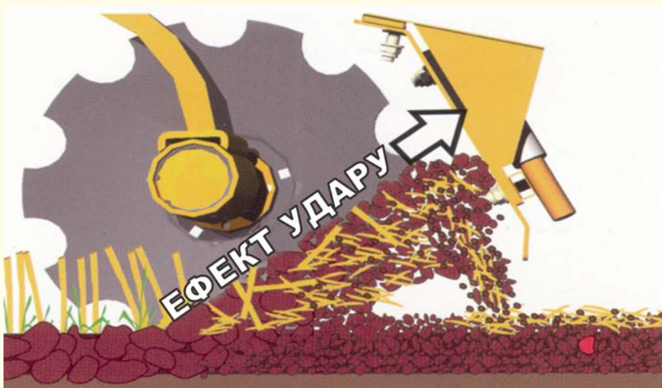
Рис. 2.11 – Схема загортання насіння з допомогою потоку ґрунту в сівалках Disc-o-Sem
