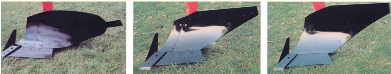
Рис. 1.2 – Форми полиць плуга фірми Gregoire Besson.
