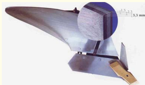
Рис. 1.3 – Загальний вигляд полиці плуга фірми "Kuhn", виконаної з тришарової триплексної сталі.
