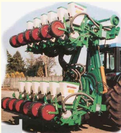
Рис. 2.25 – Загальний вигляд сівалки Sfoggia (Італія) з можливістю складання у вертикальній площині
