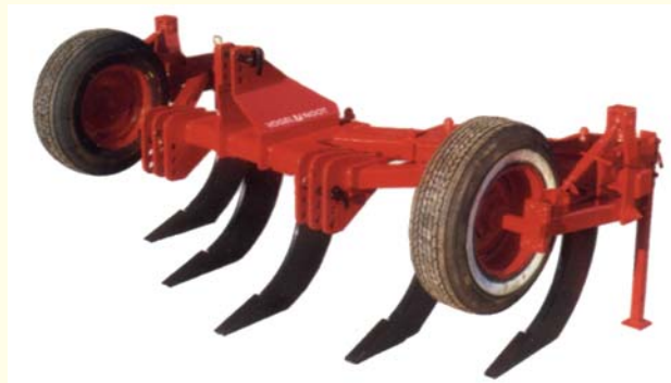
Рис. 1.19 – Загальний вигляд ґрунторозпушувача з симетричними прямими лапами.
