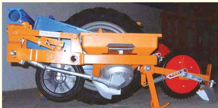
Рис. 2.22 – Загальний вигляд механічного висівного апарату сівалки SCHMOTZER UD 2012
