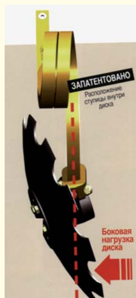
Рис. 1.11 – Пропозиція кріплення диска на віброуючий стійці фірми Agrisem International
